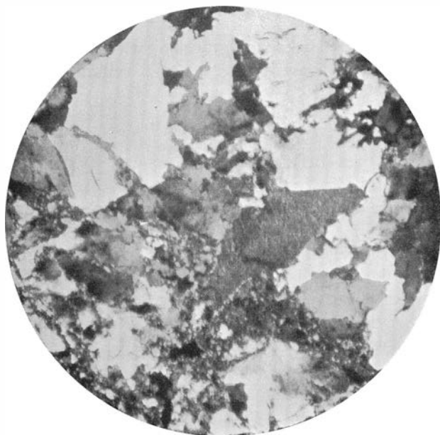
Fig. 4. Mikrofotografi av krossad »Strömskvartsit» tillhörande Tåsjöbergets kvartsitskolla. Förstoring 16 ggr; korsade nicoller.
