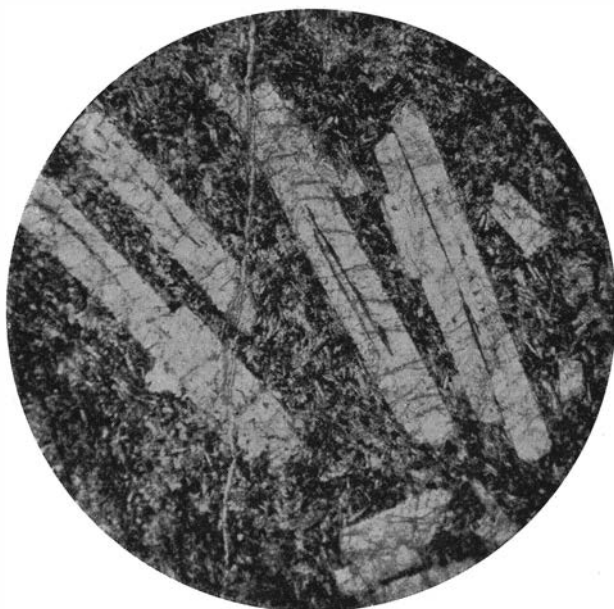
Fig. 36. Glasig diabasporfyr, kontaktform av diabasen vid »Gruvan». Förstoring 35 ggr; genomfallande ljus.
