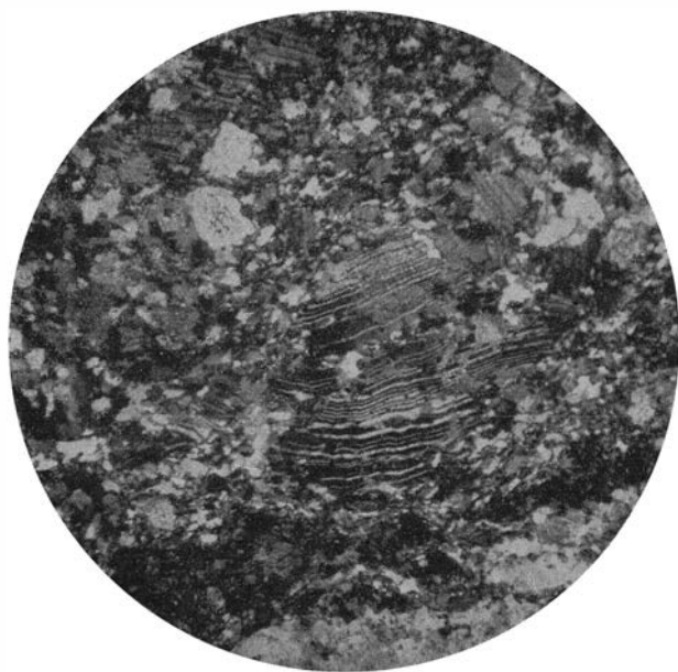
Fig. 26. Mikrofotografi av granitmylonit V intill Bågede. Förstoring 35 ggr; korsade nicoller.
