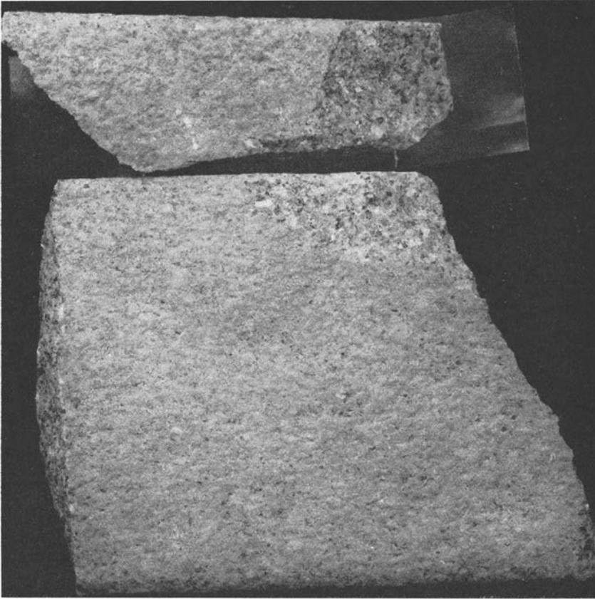
Abb. 3. Angewitterte, sandgeblasene Oberflächen (die Handstücke sind auch in Abb. 1 abgebildet; Probe N<sub>3</sub>). Photo G. Andersson.
