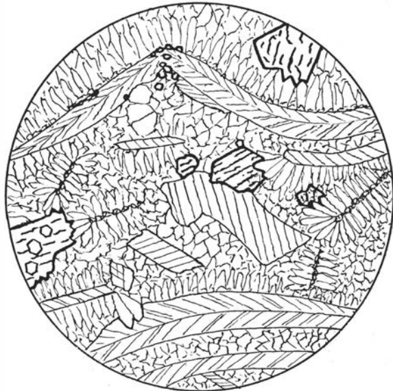
Fig. 5. Gefaltete und zerbröckelte Kalkspatlamellen mit quergestellten Quarzstengeln. In den zerbröckelten Partien mosaikartiger Quarz, grössere Körner von Epidot und sekundärem Kalkspat. Geschiebe, Geflebusen. Vergrösserung 20 : 1.
