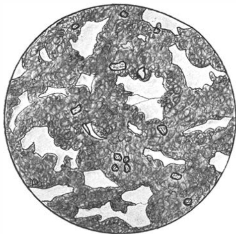
Fig. 8. Chloritgestein mit Körnern von Epidot und Albit, dieser verästelt und wie zerfressen. Streifen in Band 1, Taf. 12. Vergr. etwa 30.
