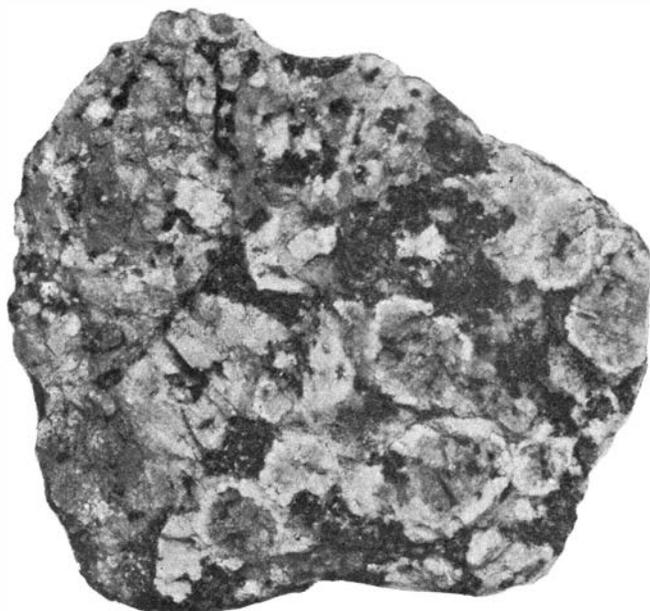
Fig. 23. Filipstadgranit. Autotypie in natürlicher Grösse nach einem Handstück. Die Orthoklaskristalle erscheinen von Plagioklashüllen umgeben. Die Zwischenmasse wird von Quarz und dunklen Mineralen, hauptsächlich Biotit ausgemacht.
