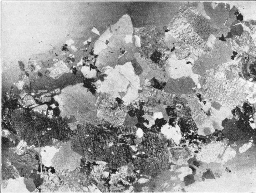
Fig. 20. Wirbgranit von Gesshult (Analyse 71). Mikrophotographie im pol. Lichte von einem grösseren Dünnschliffe. Vergr.  $2\frac{2}{3}$ .
