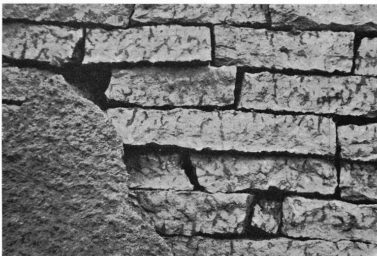
Taf. III, Abb. 2. Stapel von gebrochenem Kalkstein der Baukalksteinzone im Lügänu'schen Steinbruch. Die eisenoxydhaltigen vertikal gerichteten Adern sind als dunklere Streifen sichtbar. Verkleinerung 30 \times .
