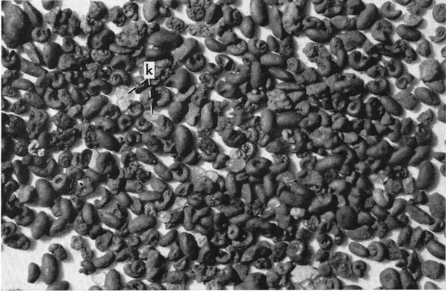
Fig. 1. In verdünnter Essigsäure unlöslicher Rückstand von *Sulcifrons*-Kalkstein, Fraktion 0,5—0,25 mm. k = Quarzkörner. Profil von Vikarbyn, Handstück Nr. D 188 (vgl. Textabb. 4).  $\times 10$ . Photo N. HJORTH.
