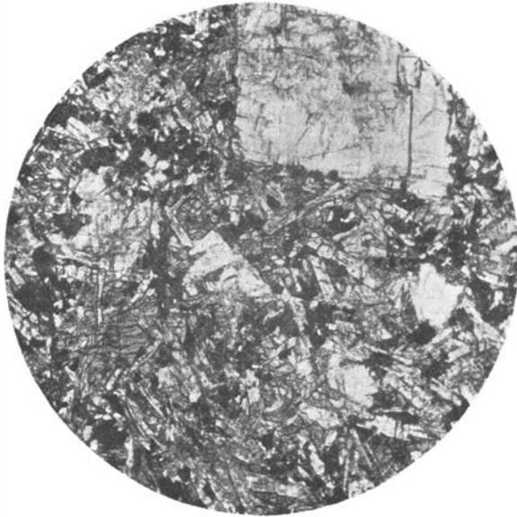
Fig. 21. *Essexitporphyrit*. Rio de Grey, westl. Estancia Ferrier. Vergr. 14  $\times$ . Mineralbestand der Mikrophotographie: Plagioklas (2 Generationen), Pyroxen u. Magnetit.
