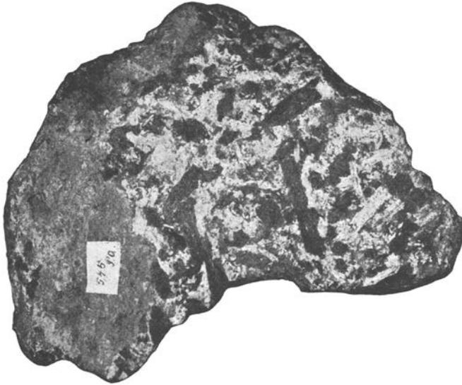
Fig. 11. *Essexit, grobkörnig. Rio Carbon.* Nat. Grösse. Die hellen Bestandteile bestehen aus *Orthoklas* und *Labradorit*, die dunklen aus *Amphibol* und *Pyroxen*.
