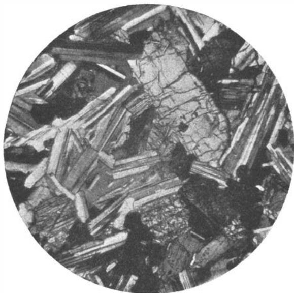
Fig. 6. *Bronzit-Orthoklasgabbro, Cerro Payne*. Vergr. 12 X. Nic. gekreuzt. Mineralbestand der Mikrophotographie: Orthoklas, Plagioklas, Diopsid, Bronzit (grosser Krystall in d. Mitte des Dünnschliffes) und Magnetit.
