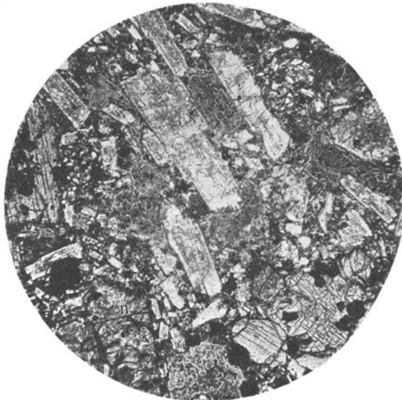
Fig. 23. *Trachydolerit (Shoshonit), Skyring Water*. Nordufer, am Fuss des Cerro Pinto. Vergr. 12  $\times$ . Mineralbestand der Mikrophotographie: Plagioklas, Pyroxen, Serpentin, Pseudomorphosen nach Nephelin? (N), Magnetit.
