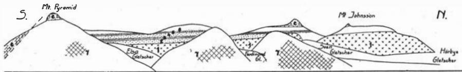
Fig. 6. Schematisches Profil längs der Westseite der Billenbay nördlich von der Mimerbay. C Cyathophyllumkalk; 1 Urgebirge; 2 gelber Sandstein; 3 unterer Schiefer-Kohlenhorizont; 4 gelber Sandstein; 5 oberer Schiefer-Kohlenhorizont; 6 roter Sandstein; 7 gips-haltige Schichten, die gegen den Beschauer fallen. Länge des Profils beinahe 11 km. Höhenmasstab übertrieben.
