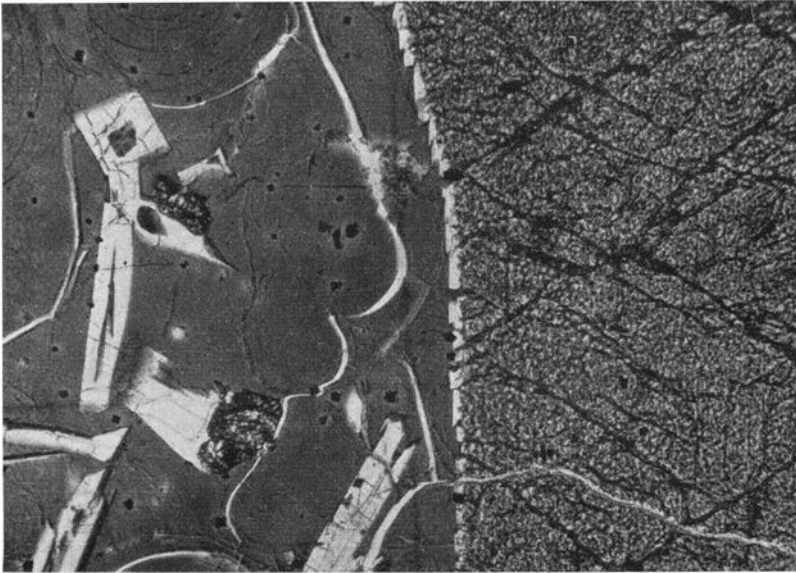
Fig. 3. Dellenit, Kallerö. Rechts grosser resorbierter Plagioklaskristall von einem glasklaren Saum jüngeren Plagioklases umgeben. Gew. L. Vergr. 45\times (Foto A. SAGERHOLM).
