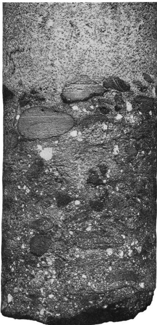
Fig. 4. Bottenlagret av zonen med Megalaspis planilimbata bildat av ett sandstenskonglomerat med grova kvartskorn (vita) och bollar av mörkbrun tät fosforit och fosforitsandsten. Överlagras av grå glaukonitförande sandsten.
